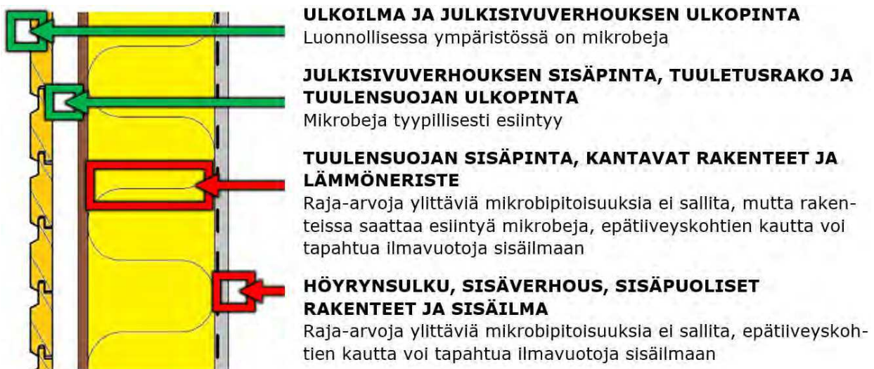
Kuva 89. Mikrobin esiintyminen ja merkitys rakennusvaipan eri osissa. (Muokattu RIL 250-2011. Kosteudenhallinta ja homeenehkäisy -julkaisun pohjalta).
